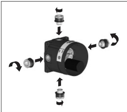
Montage der beigefügten Gewinde-nippel mit Formdichtung. Der Gummikragen muss pressend an der Box liegen. Die Nippel müssen wie üblich mit Dichtmaterial versehen werden.
