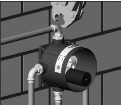
Anschließen der Leitungen. Nach der Fertigstellung der kompletten Installation, muss diese auf Dichtigkeit geprüft und gespült werden. Im Abgang der Mischwasserleitungen dürfen keine Absperrventile nachgeschaltet werden.
