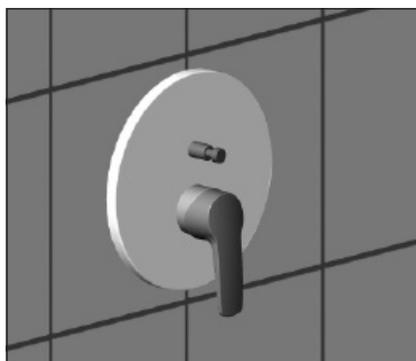
Aufstecken des Mischerhebels. Mit Gewindestift (SW 2,5) fixieren. Verschlussstopfen abschließend einstecken.
